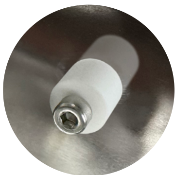
Électrode située sur la paroi interne de la chambre de stérilisation, juste au-dessus du serpentín d'eau.
