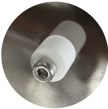
Electrodo situado en la pared interior de la cámara de esterilización, justo encima del serpentín de agua.
