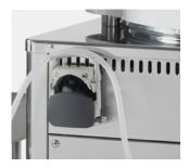
2. Revisar que la línea de dispensación no esté pinzada por la bomba peristáltica o la estación de dosificación externa.
