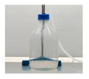
3. Colocar la boquilla metálica de la línea de dispensación en el interior de la botella suministrada.
