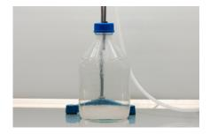
3. Colocar la boquilla metálica de la línea de dispensación en el interior de la botella suministrada con el preparador de medios.
