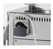
2. Revisar que la línea de dispensación no esté pinzada por la bomba peristáltica o la estación de dosificación externa.
